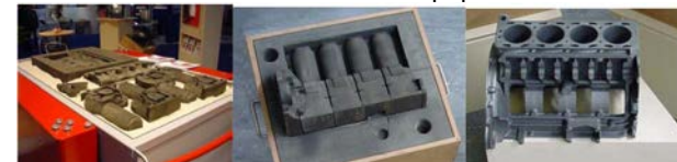
Выращенные фрагменты формы (ProMetal), форма в сборе и отливка блока (чугун)
