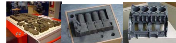
Выращенные фрагменты формы (ProMetal), форма в сборе и отливка блока (чугун)
